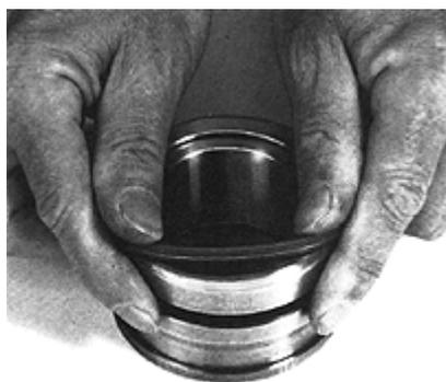
Уплотнение укладывается в канавке одной стороной и постепенно проталкивается через предварительно смазанный корпус поршня, пока полностью не сядет в канавку.
